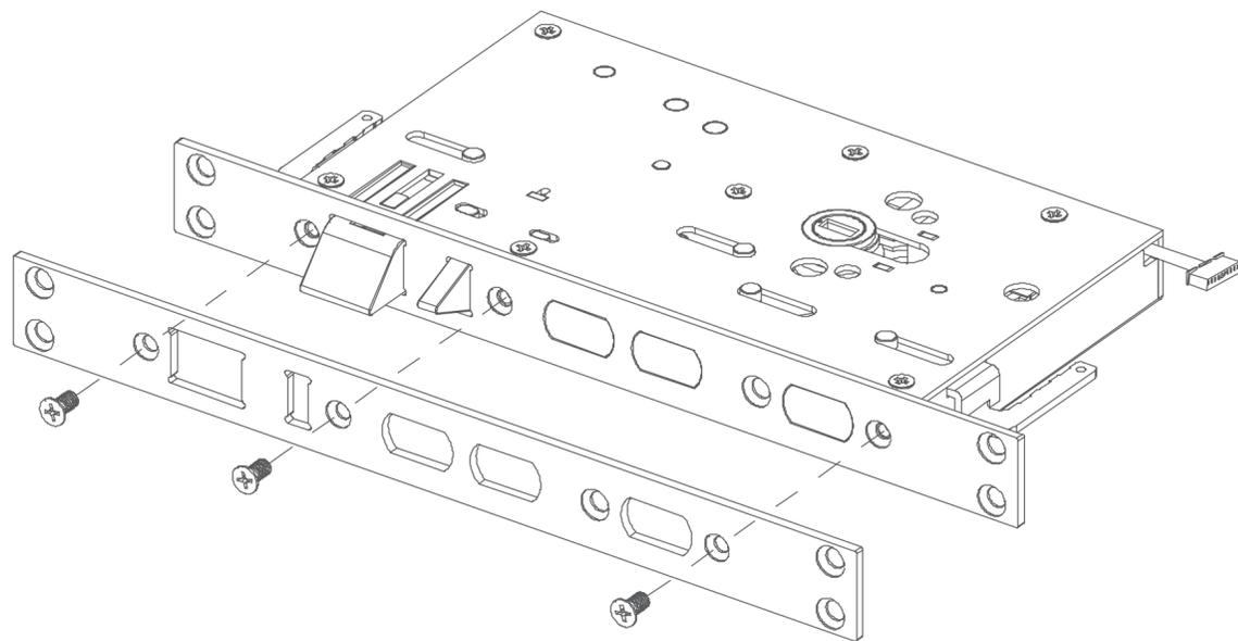
注：霸王锁体更换导向板和斜舌换向，操作同标准锁体。
