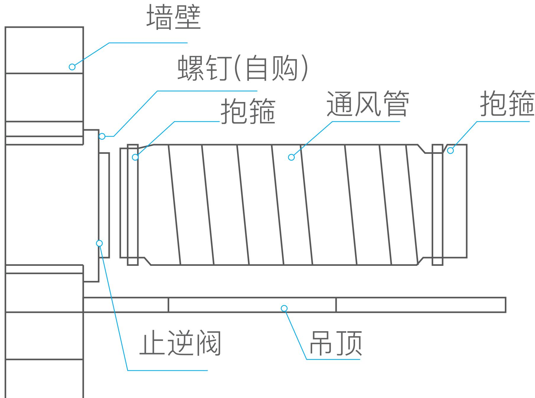
1. 适宜在墙壁外安装的用户，请按下图进行安装；
