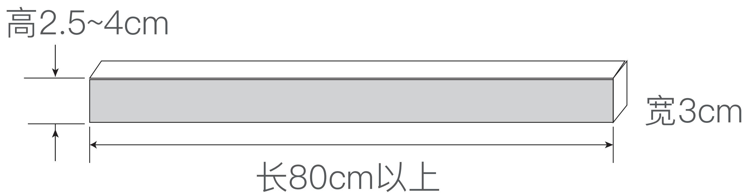
4. 将主机置入石膏及木质吊顶开孔木条上方；
