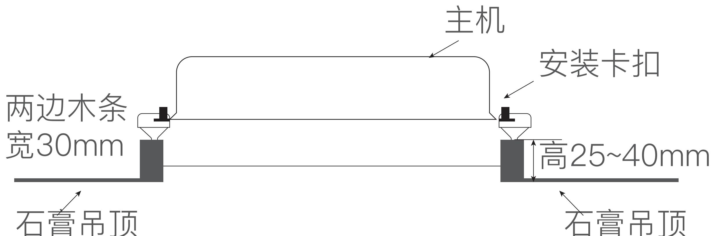
7. 将转换框固定在开孔内；
