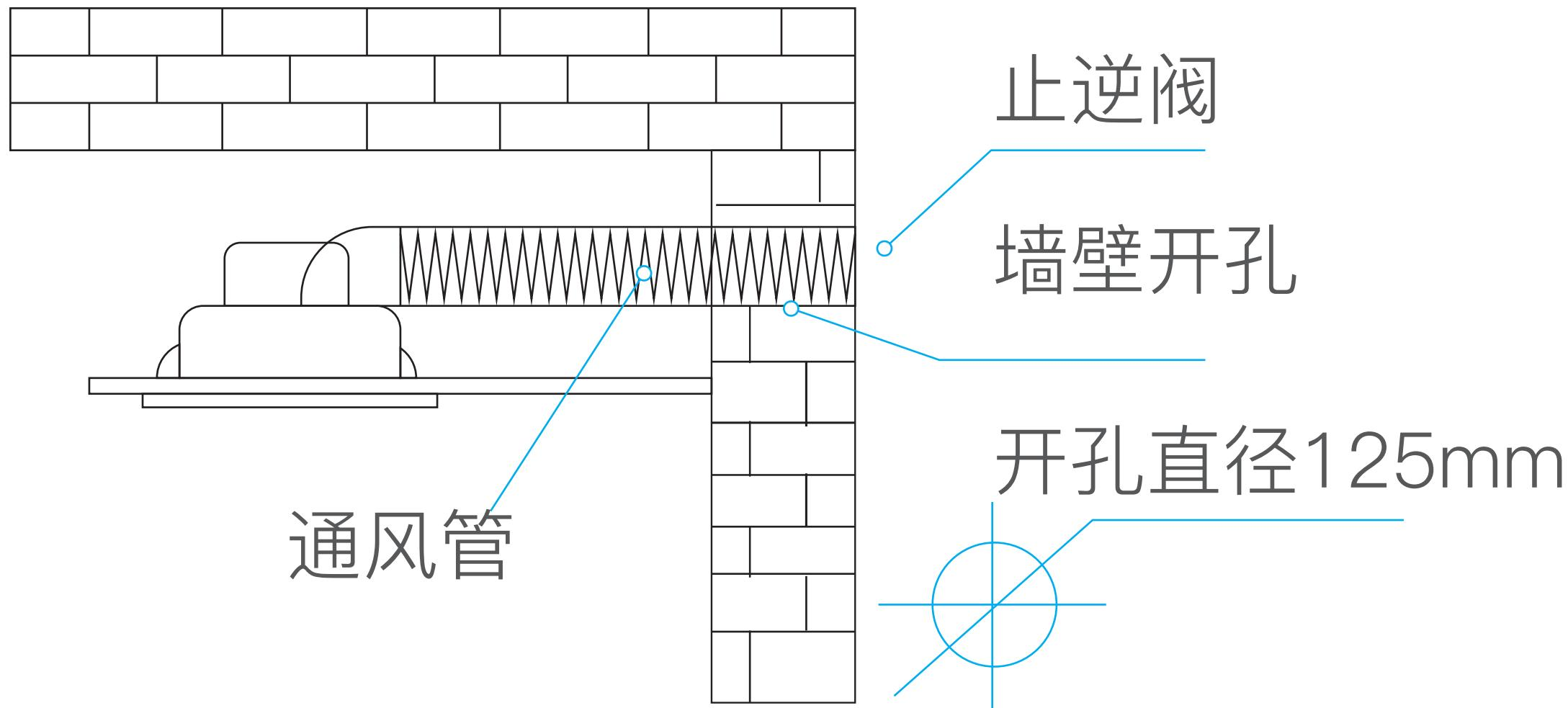
2. 不适宜在墙壁外安装的用户，请按下图进行安装；
