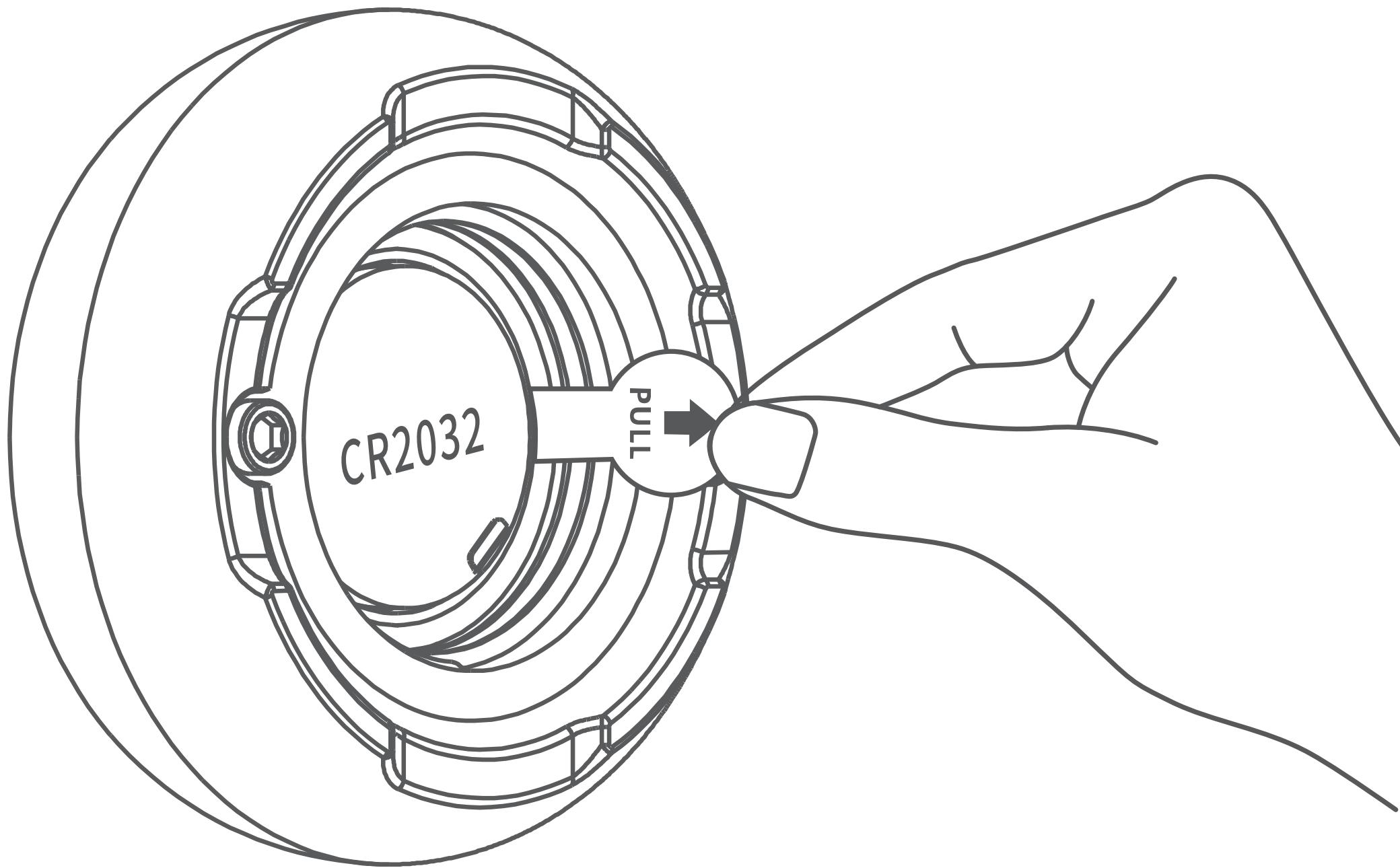
取出电池绝缘片，产品通电后合上电池盖。
