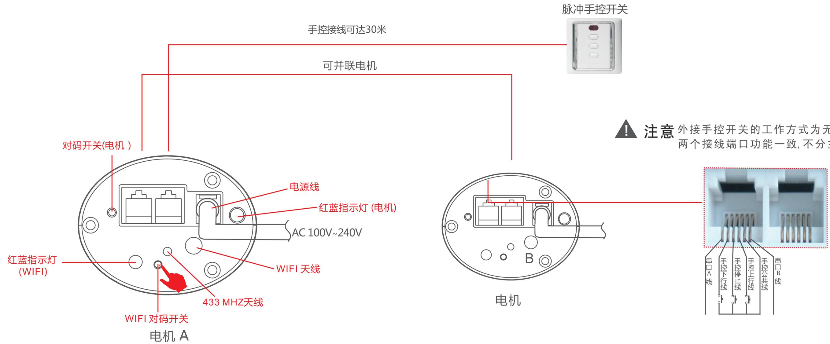
**注意** 外接手控开关的工作方式为无源干触点模式，两个接线端口功能一致，不分主副接口。
