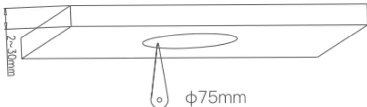
2、如图所示：断电后分别将灯具电源线按零线、火线对应连接，后将灯具放入天花板内。
