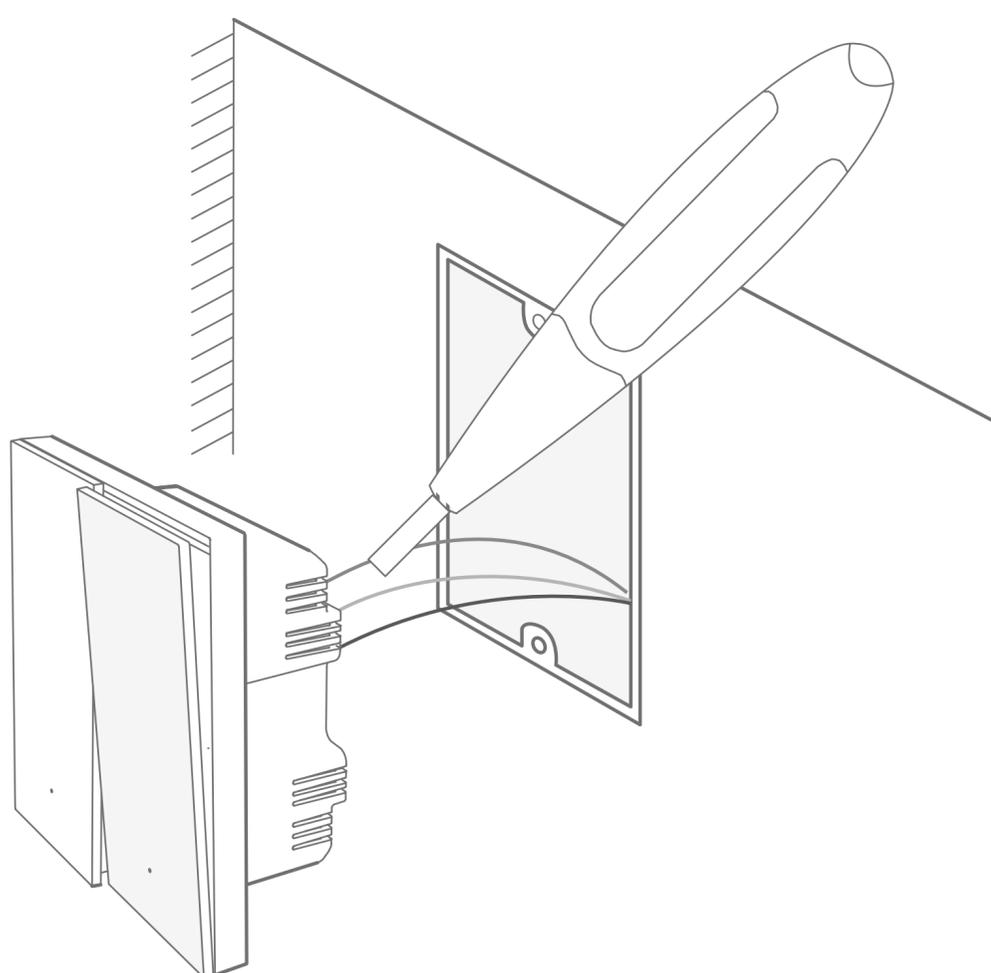
3、关闭断路器，用电线贴纸标记电线后将墙壁面板取下。
