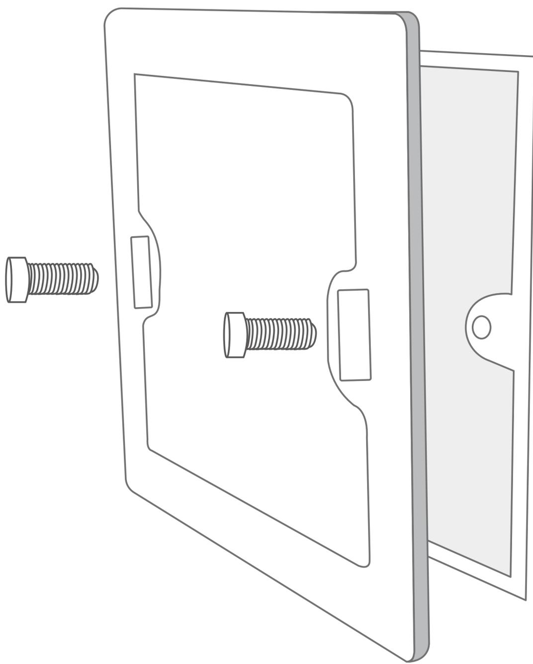
\*电源底盒固定螺丝拧至底壳不晃动即可，过紧将导致MixPad精灵触屏语音开关和电源底盒扣合时不牢固或不平整。
