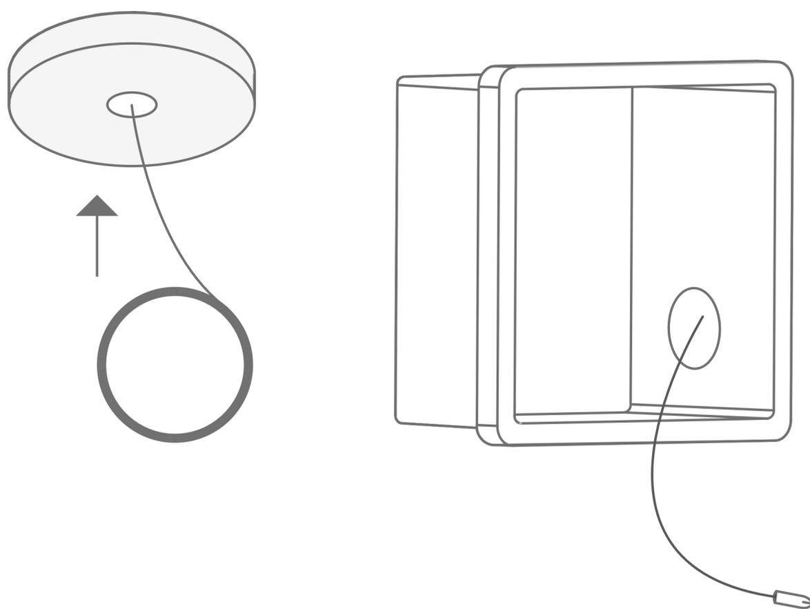
③ 将新增电线和穿线器头部固定，灯具位置抽拉穿线器带出新增电线。
