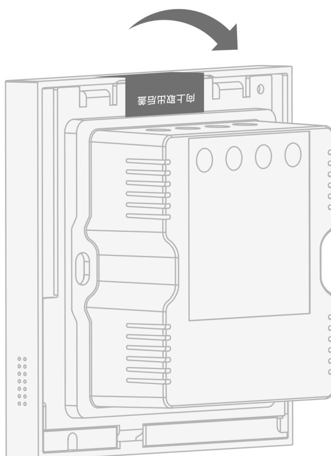
③ 将火线接入底盒的L接口，零线接入底盒N接口，灯控线接入底盒L1/L2接口。确认接线正确后，拧紧接线柱螺丝。
