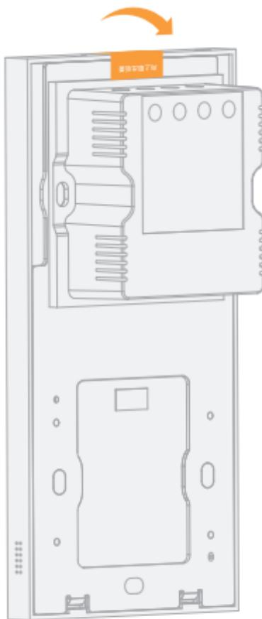
③ 将火线接入底盒的L接口，零线接入底盒N接口，灯控线接入底盒L1/L2接口。确认接线正确后，拧紧接线柱螺丝。
