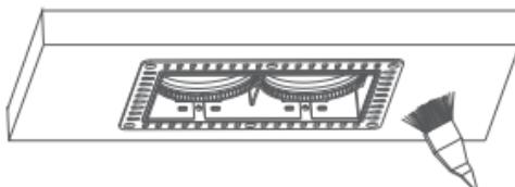
5、如图所示：断电后分别将驱动电源线按零线、火线对应连接，再将驱动放入天花板内，拉出两根接口线分别于两个面框口内，后将灯具接口线逐个对接在驱动的端口上，将灯体垂直向上推入面框内。
