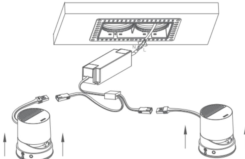
6、将防眩杯侧面卡扣对准天花内面框卡扣，垂直向上推送即可；
