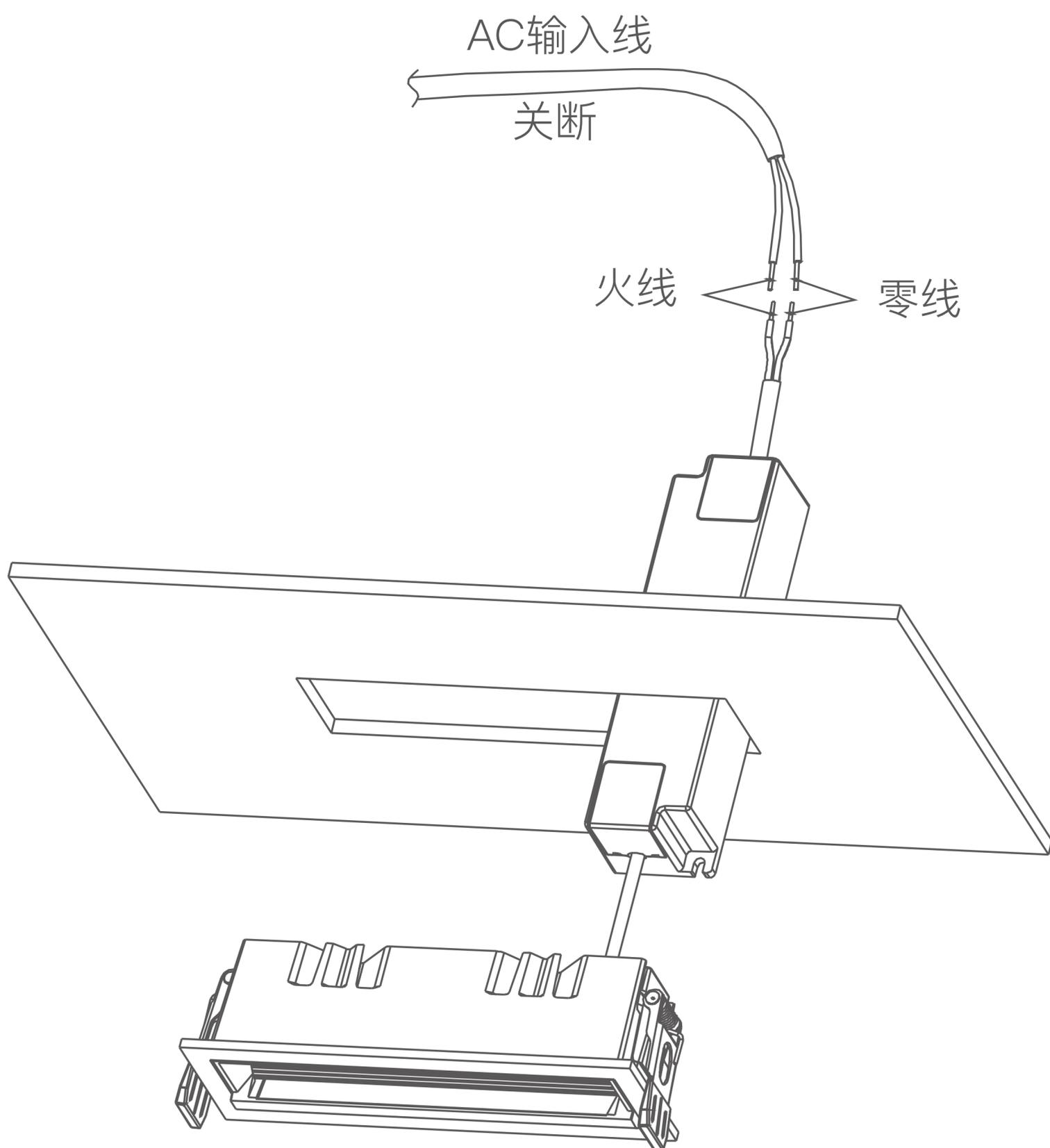
3、扭转灯具两侧弹夹向上，将灯具扣入天花板开孔内。
